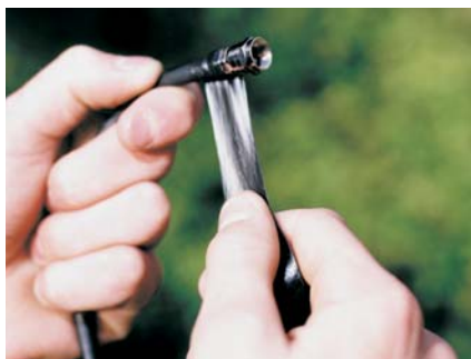
Het intapen van een F-connector/ afschermtube LNB
